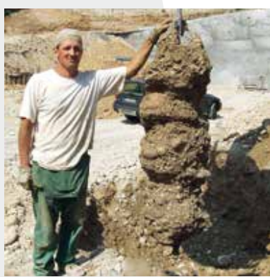
<< Ancoraggi Flottanti realizzati con unità di perforazione a rotopercolazione esterna della lunghezza di 55 m. Ancoraggio composito ø76 mm, bit ø140 mm, forza massima 3200 kN. << Floating anchor produced with a 55 m-long external rotary percussion drilling unit. Composite anchor ø76 mm, bit ø140 mm, maximum strength 3200 kN.
